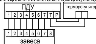
**Внимание!** Терморегулятор (опция), не должен располагаться в зоне воздушного потока завесы, иначе его срабатывание будет зависеть от температуры потока. Это приведёт к частому переключению реле, включающих обогрев, что снизит ресурс их работы.
