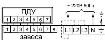
Схема подключения T206E10, T209E10, T212E20, T218E20, T309E10, T318E20 к трёхфазной сети и ПДУ.
