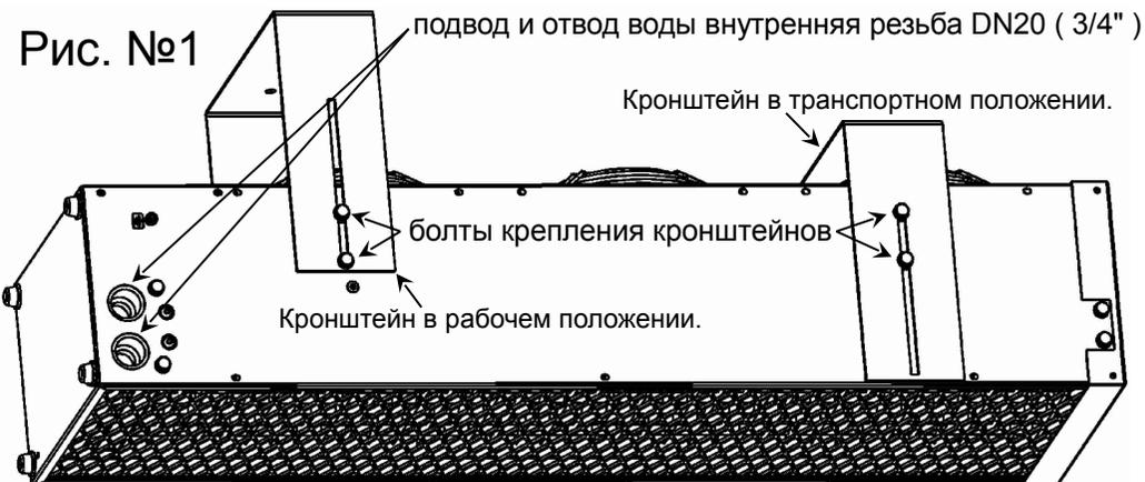
Теплоventильатор рассчитан на установку горизонтально и вертикально, но необходимо учитывать возможность слива воды и образования воздушных пробок. Оптимальное расположение линий подвода и отвода воды должен определить *квалифицированный* сантехник.
